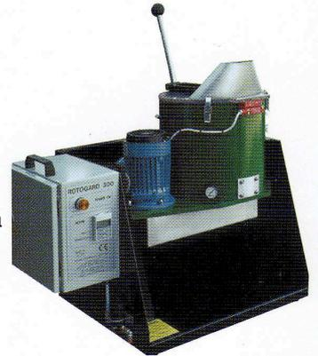
Se puede hacer aplicaciones simultáneas y secuenciales sin límite, y el aire de secado puede aumentar el índice de evaporación de solventes o suspensiones. De esta manera, las capas de añadidos se pueden aumentar hasta que modifican la dimensión de la partícula o aumentan el tamaño.
