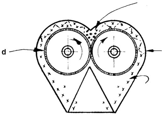
La máquina para limpiar los porotos es muy simple. Tiene varios rollos que giran haciendo saltar a los porotos que tiene una superficie no lisa.
